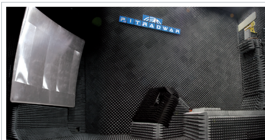
MVGコンパクトアンテナテストレンジ - PitRadwarのために作られたフルターンキーソ リーシ
