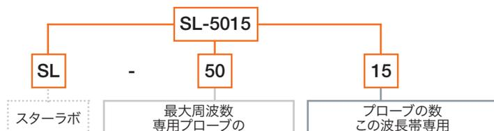
このモデルでは、15個のプローブ+1つのリファレンスチャンネルを使用して、18~50GHzの周波数を測定することができます。
