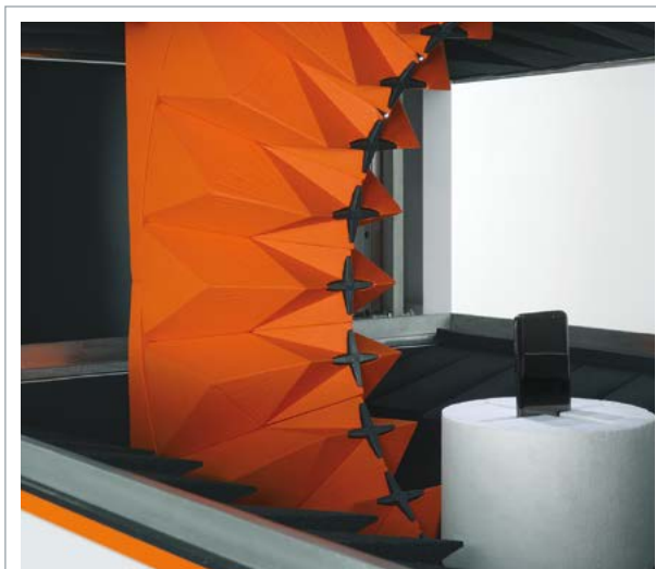
MiniLAB I 6 GHz OTA门打开时的内部视图
